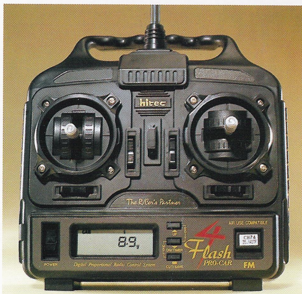
Exemple d'émetteur « stick » avec les contrôles indispensables.
