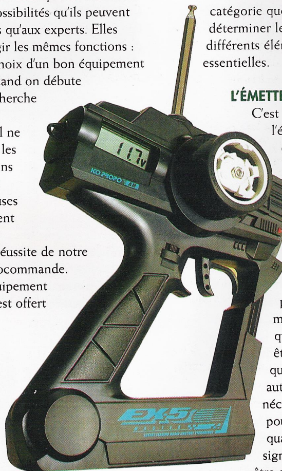
Sur l'émetteur à volant, la roue ou le volant contrôlent la direction tandis que la gâchette actionne l'accélération du véhicule.
